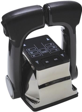
・モデル名 KE-4+ 電子リモートコントロールシステム
