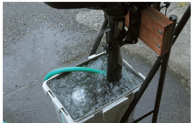
水冷式船外機の場合、使用後に冷却水取り入れ口から清水が供給される状態で運転し、冷却海水が通る経路を洗います
