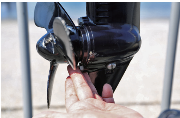
プロペラの付け根に釣り糸を巻き込んでいると、シーリングが破れて大きな故障の原因になることもあります。日常的にチェックしましょう
