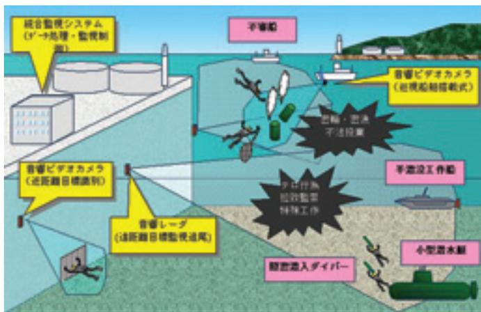
科学技術振興調整費により、国民生活の安全を守るため、日本の沿岸に多数存在する石油関連施設、港湾施設、発電所等の重要施設やLNG・石油タンカー等に対するテロ行為、および地上から可視困難な海中空間で発生する各種犯罪を防止し、隠密潜入する小型潜水艇、ダイバー等の危険な目標を音響によるレーザ探知により遠距離から監視追尾し、近距離では高分解能の音響ビデオカメラにより目標を識別することにより統合的な監視を実現する水中セキュリティソーナーシステムの開発を行っています。
